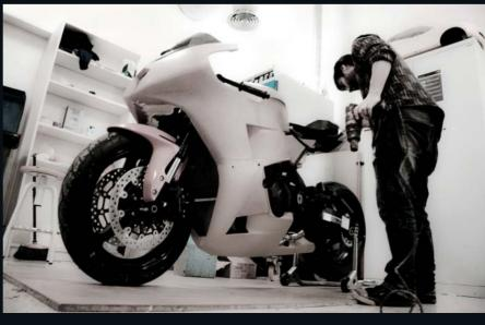
el motor físicamente en el banco de trabajo, hay que empezar a fabricar el chasis fabricando el potro y soldando los distintos tubos. Al mismo tiempo se avanza con el diseño en CAD del resto de los elementos propios para tener el proyecto definitivo acabado. Lo habitual es diseñar todo antes de empezar a fabricar nada, pero hay veces en que el tiempo aprieta... bueno, normalmente siempre.
