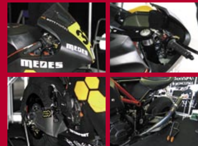
Chasis multitubular de acero y basculante de aluminio de grandes proporciones son la base de una parte ciclo que, en pista, muestra una eficacia sobresaliente.
